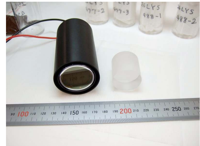
↑ 実際に使用予定のPMT(H-8409-70) とLYSO結晶(φ 30mm × 30mm)
