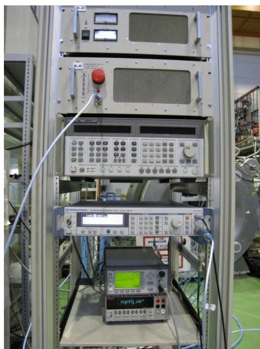
図 4.17: 500W CW ユニットと Signal Generator
