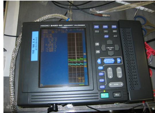
図 3.3: 室温、湿度、酸素濃度など実験室におけるいろいろなパラメーターを総合的にモニターする (gekimon)
