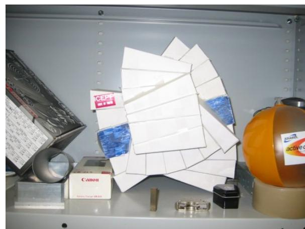
図 2.38:  $4\pi$  検出器のミニチュア模型
