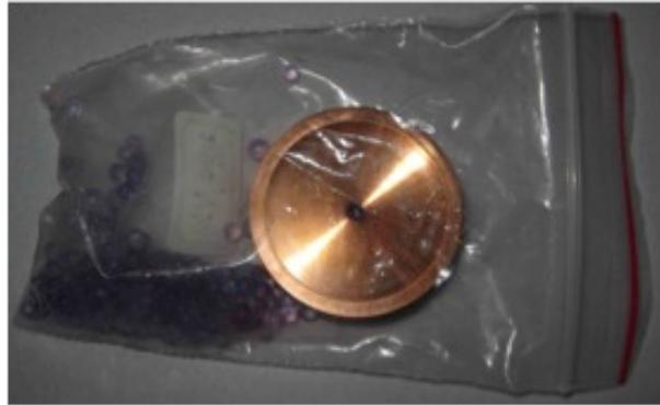
図 2.4: ジャイロトロンの空洞共振器.
