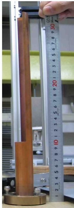
図 2.27: ステップカット導波管
