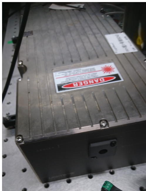
図 4.5 LIGHTWAVE210G の写真。共振器中の Ti:Sapphire 結晶を励起するのに用いた 532 nm パルスレーザーのヘッド部分を撮影したものである。
