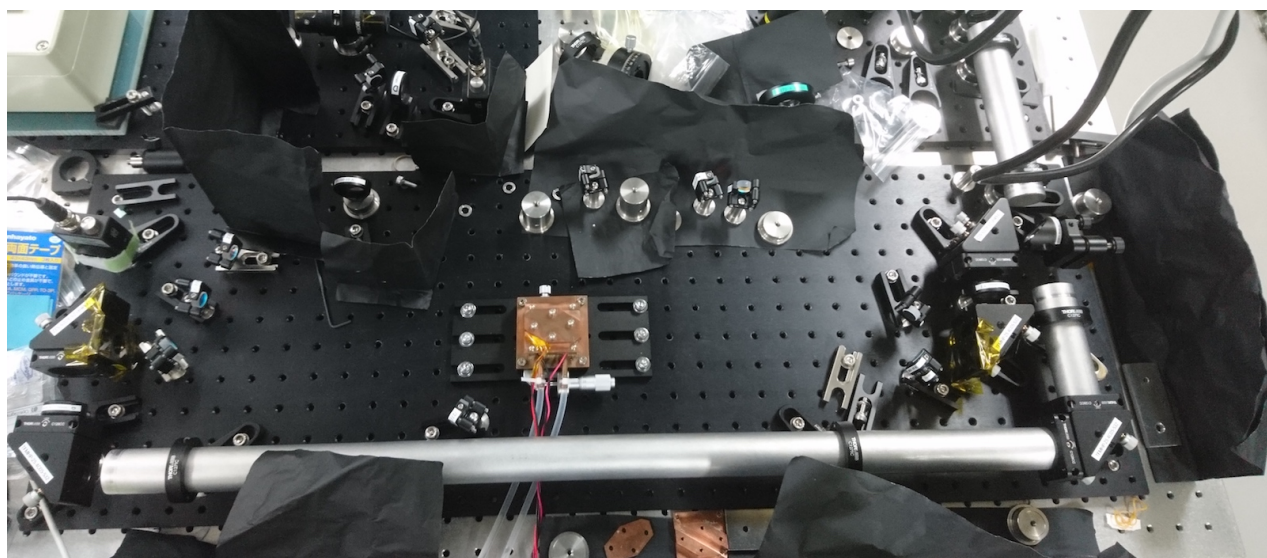
図 5.4 マルチパス増幅の光学系。写真の中央にある Ti:Sapphire 結晶に両側から 532 nm パルスレーザーを照射して励起する。729 nm パルスは今回は 2 回結晶を通過させている。
