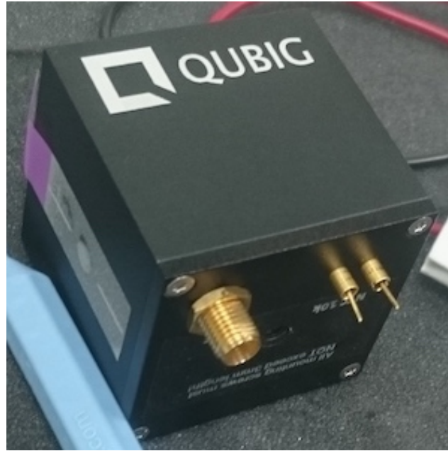
図 7.2 線幅拡大用の EOM。立方体型 (4 cm × 4 cm × 4 cm サイズ) の装置であり、SMA 端子から RF 電圧を印加することが出来る。
