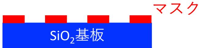
2. エッチングによりSiO<sub>2</sub>基板に穴空け，最後にマスクを除去
