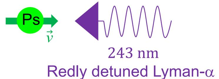
Photon recoil velocity : 1.5 km s<sup>-1</sup>
